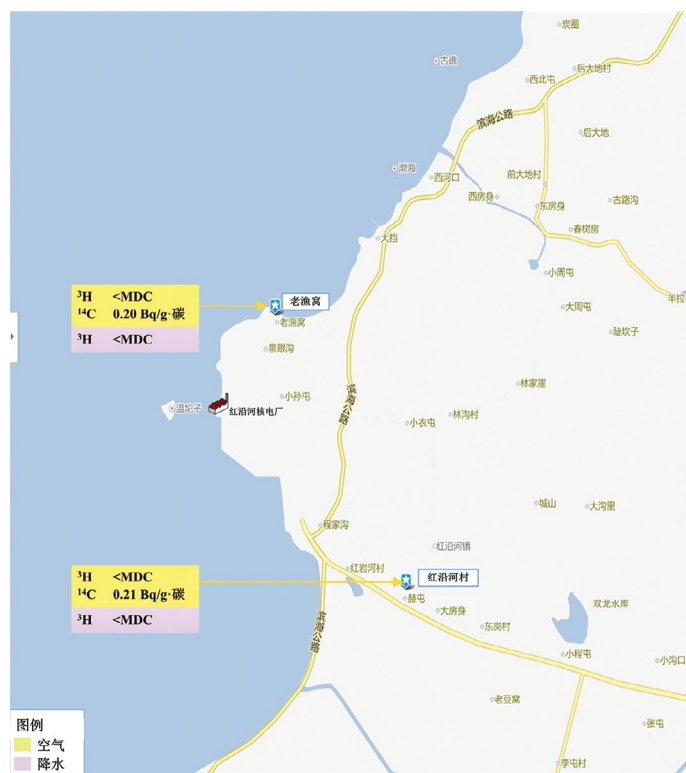
■ 图4.5-2 红沿河核电厂周围环境空气中氚化水 (HTO)、碳-14及降水中氚监测结果
