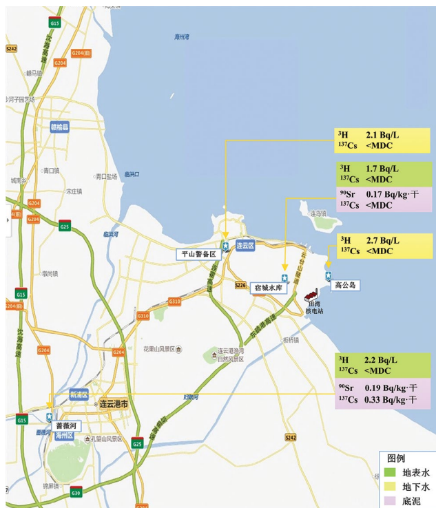
图4.4-4 田湾核电站周围环境地表水、地下水及底泥监测结果分布示意图
