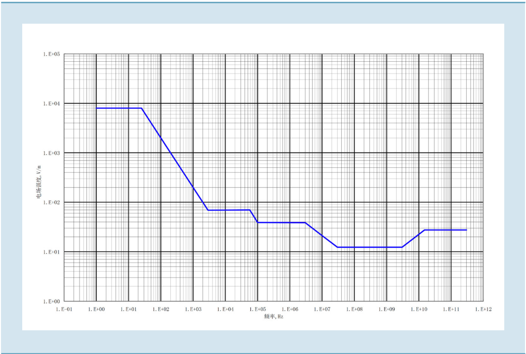
图 1.4-2 公众曝露电场强度控制限值与频率关系
