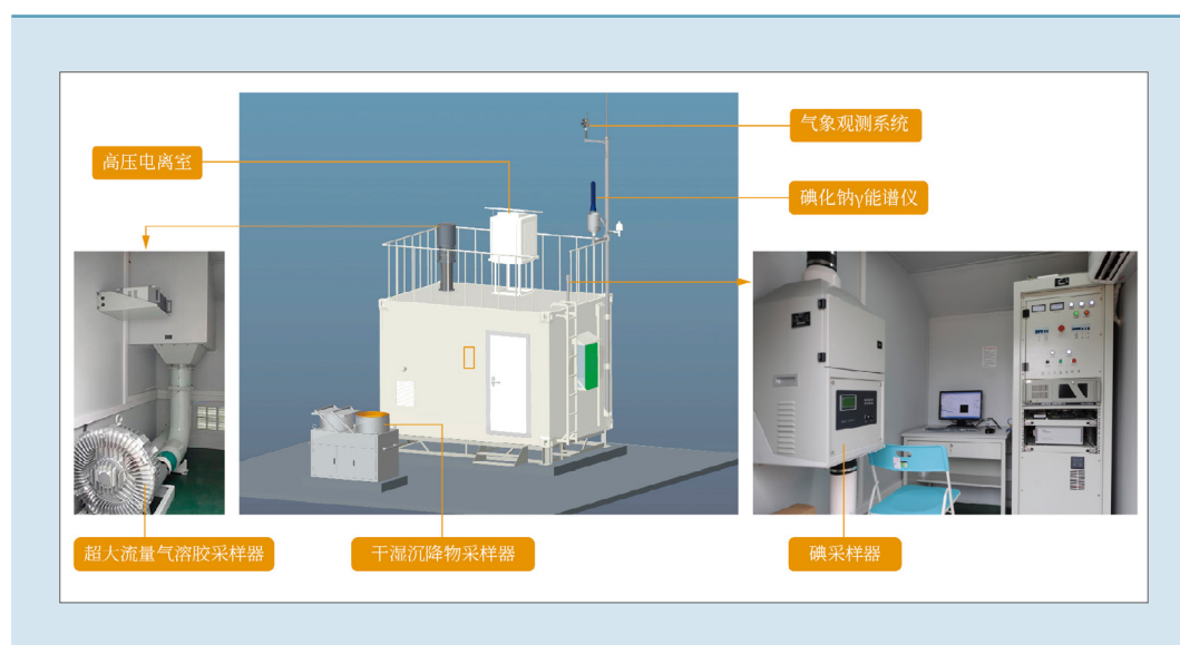
图 2.2-2 自动站配置示意图
